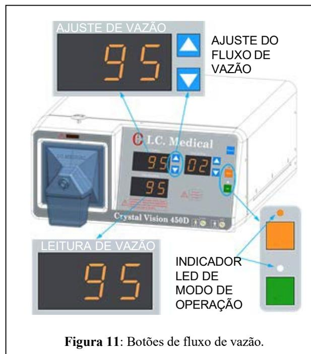
**Figura 11:** Botões de fluxo de vazão.
