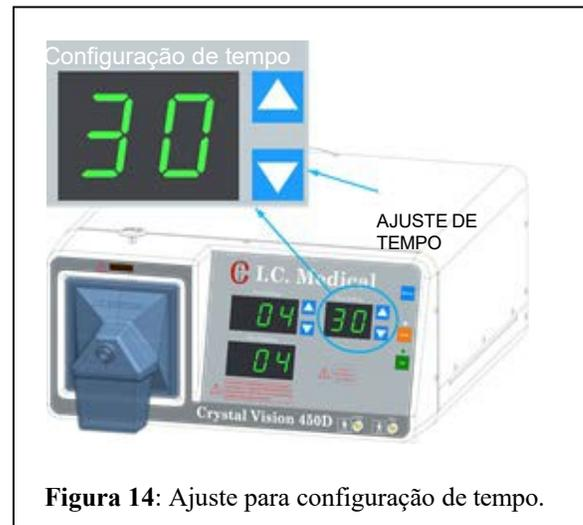
Figura 14: Ajuste para configuração de tempo.
